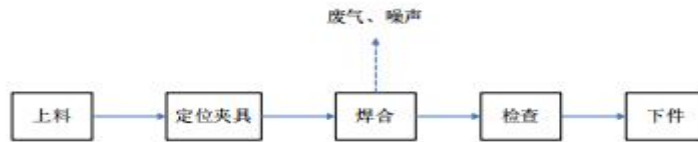
图4-1 焊装车间1工艺流程及产排污节点图
